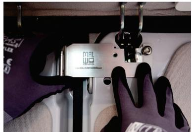
4. Drehen Sie nun die 2 restlichen Schrauben wieder ein und ziehen Sie diese leicht an
