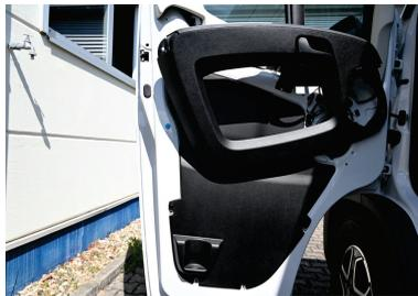
6. Die Tür ist nun freigelegt und die Schaumstoffversiegelung ist zu erkennen. Lösen Sie die Versiegelung im oberen linken Bereich so dass Sie Zugriff auf das Türschloss haben. Entfernen Sie auch die Abdeckung (B) hinter dieser Abdeckung haben Sie direkten Zugriff auf die linke Schraube vom Schloss. Die rechte Schraube sehen Sie durch die entfernte Schaumstoffabdeckung. Lösen Sie beide Schrauben mit der 10er Nuss.
