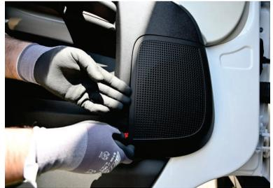
3. Entfernen Sie die obere linke Abdeckung. Auch hier verwenden Sie den Clip Heber.
