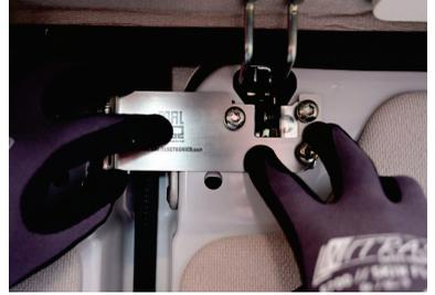
5. Wenn beide Verriegelungen montiert sind richten Sie die bitte aus und ziehen danach alle Schrauben wieder fest an
