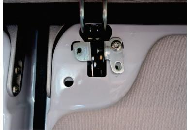
3. Schieben Sie nun die Verriegelung unter die herausgedrehte Schraube oben rechts, und ziehen Sie diese leicht fest
