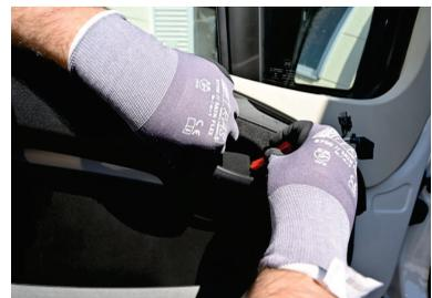
5. Nachdem alle Abdeckungen demontiert sind, sehen Sie alle Schrauben welche gelöst werden müssen. Nachdem alle Schrauben entfernt worden sind kann die obere Abdeckung nach links geschoben werden um diese dann nach oben zu entnehmen.
