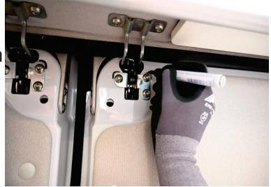
2. Mit dem Torx TX40 Schraubendreher lösen Sie bitte die Schraube oben rechts. Die Schrauben oben links und unten rechts drehen Sie bitte komplett heraus
