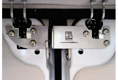
6. Zum Verriegeln der Tür schieben Sie den mitgelieferten Splint durch die beiden unteren Löcher und drücken den Haltering Richtung Bolzen.
