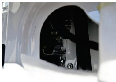
7. Setzen Sie den Einbruchschutz ein. Bitte beachten Sie die Einbaurichtung. Die abstehenden Laschen müssen von der Montageposition nach außen zeigen. Schrauben Sie den Einbruchschutz nun fest. Montieren Sie nun wieder alle Verkleidungsteile in umgekehrter Reihenfolge.
